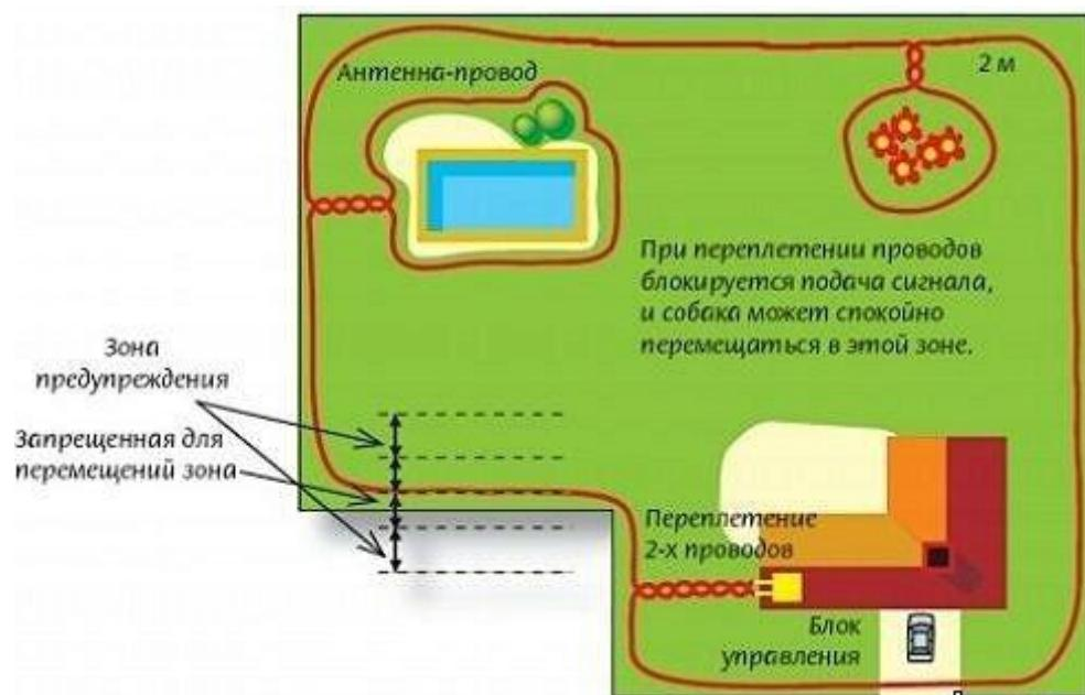
**ВАЖНО!** • Не устанавливайте провод длиной менее 15 метров, иначе передатчик перегорит.
